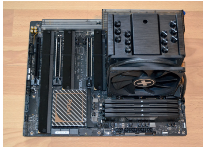
Das Mainboard mit aufgesetzten SSD- und CPU-Kühlern.
