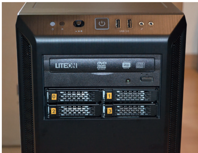
Ansicht von vorn mit 2 x USB 3.0, dem LiteOn DVD Laufwerk und dem Wechselrahmen für die SATA-SSDs
